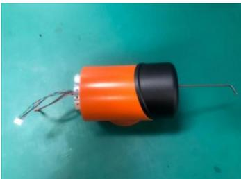
2) 将关节电源线和通讯线穿过连接的下个关节，整理好线以免两个关节连接时压线, 如下图所示：
