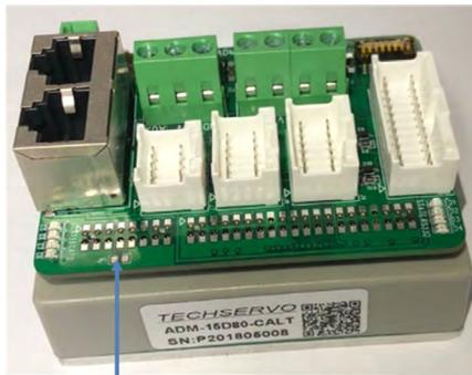
JP1短接，表示在CAN\_L与CAN\_H之间并联一个120欧姆的终端电阻，不短接表示不并联电阻
